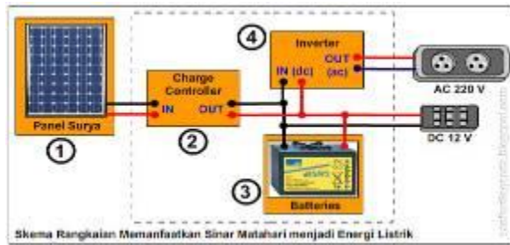
Gambar 2. Skema Rangkaian Sinar Matahari Menjadi Energi Listrik
