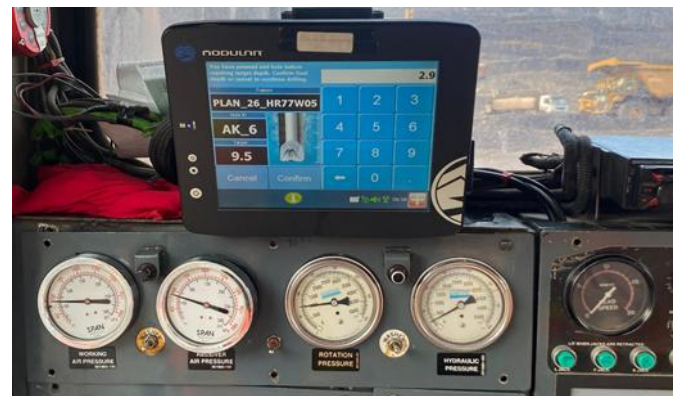
Gambar 2. Monitor Dispatch pada Kabin Drill
