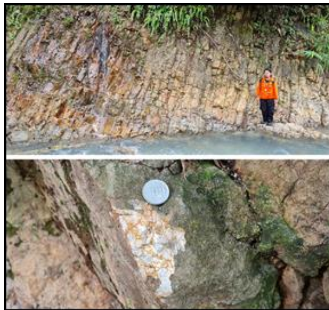
Gambar 12. Sampel HL 3. pada singkapan batuan beku dasit dengan ketebalan kurang lebih 5 meter secara keseluruhan singkapan tersebut terendapkan pada dinding sungai besar tahoku, menunjukkan kenampakan struktur kekar tiang dengan kemiringan lereng 350.
