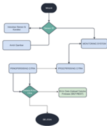
Gambar 2. Flowchart Logika Alat Monitoring Dan Penghitung Hasil Panen Berbasis Internet Of Things (Iot)
